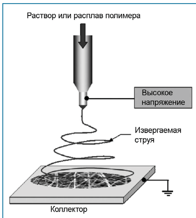
Рис. 1. Схематическое представление процесса электроспиннинга
