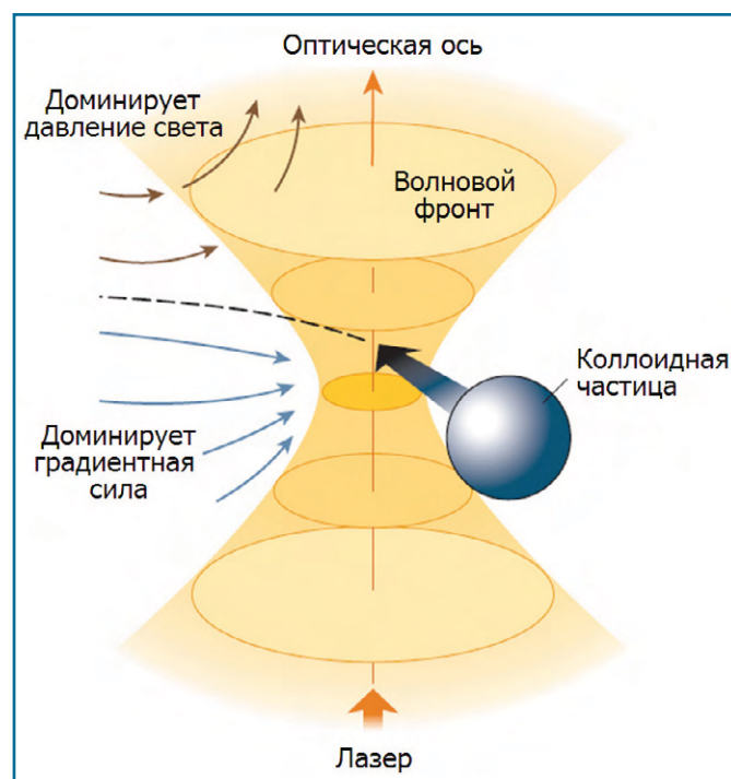
Рис. 1. «Захват» коллоидной частицы оптическим пинцетом
