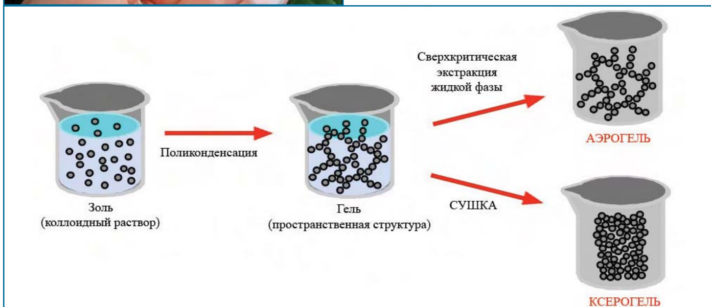
Рис. 1. Схематичное представление золь-гель процесса
